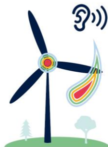
Figur 24. Illustration av var ljud uppstår vid ett vindkraftverk i drift.
